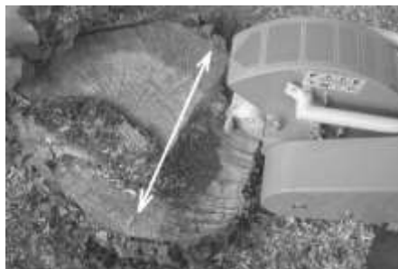
Lavoro: fate fare alla fresa un movimento oscillatorio rimuovendo poco materiale ad ogni successivo passaggio.
